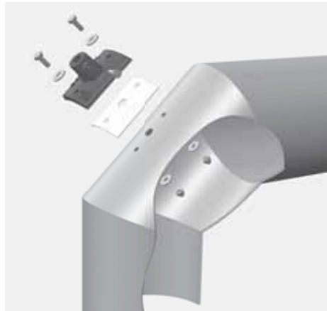
Abb. 3.1 Position des Thermoelements bei senkrechtem Heizgasstutzen
